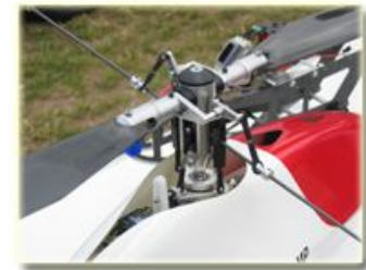
Moderner Rotorkopf eines Tree- Dee MP von Jan Henseleit
