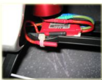
Detail Regler und Unterbringung der Empfängerakku-Versorgungsleitung
