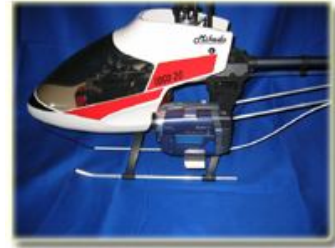
Mit angebrachter Videokamera für Luftbildaufnahmen
