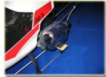
Der Logo 20 mit seitlich montierter Videokamera
