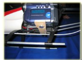
Hier ist die Kamera befestigt. Die Schraube ist einem Stativ entliehen.
