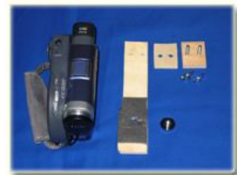
Die Einzelteile der schnell zu montierenden Aufhängung
