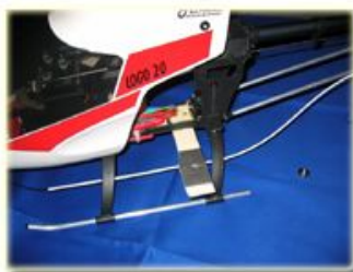
Auf dieser simplen Halterung kann nun die Videokamera mittels Stativschraube montiert werden.
